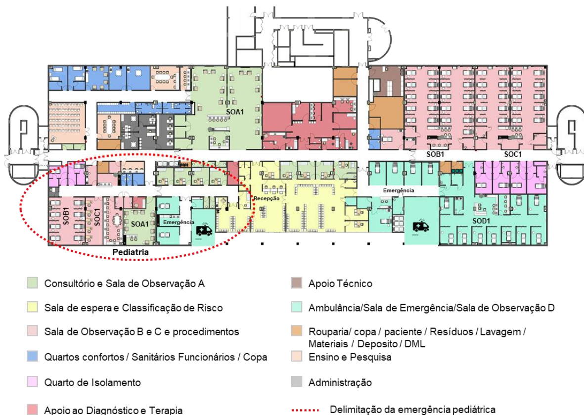
Figura 24 – Zoneamento do espaço futuro da emergência
