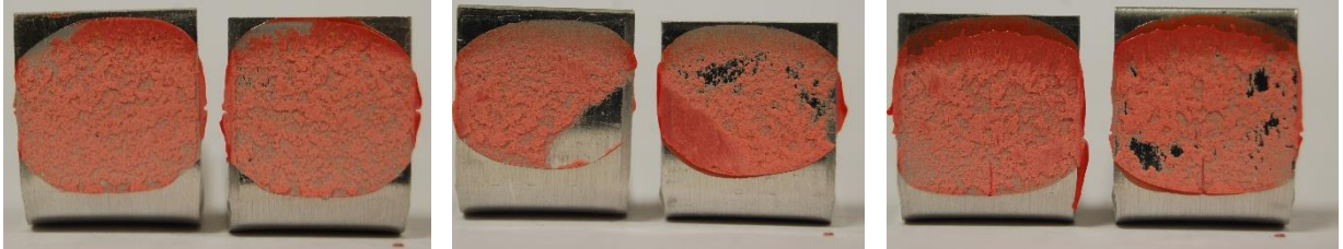
Figura 40 – Superfície dos adesivos das amostras de ensaio de descascamento rompidas.
