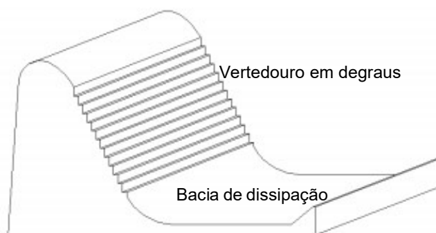
Figura 1 – Vertedouro em degraus com bacia de dissipação por ressalto hidráulico.
