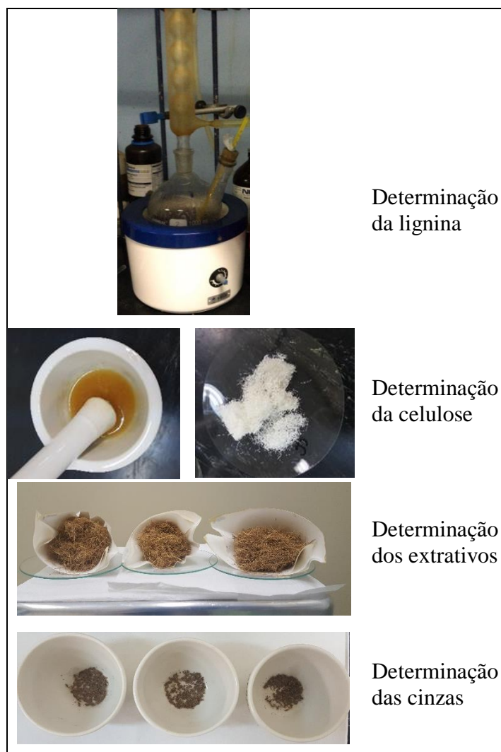
Figura 30. Imagens das análises de composição química das fibras vegetais.
