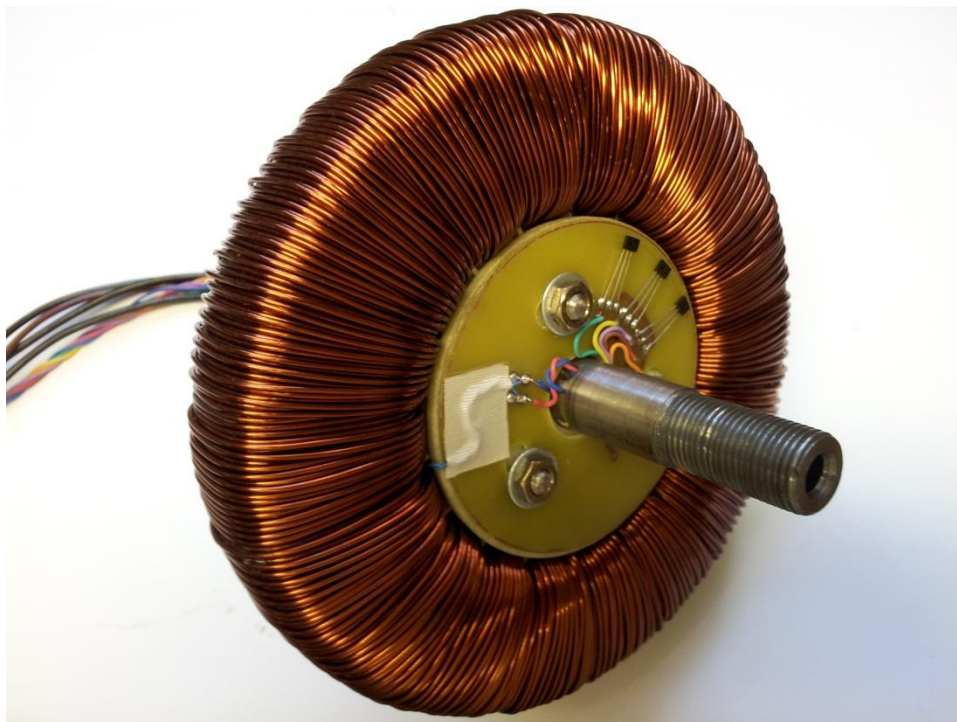
Figura 4 – Armadura ferromagnética toroidal sem ranhuras, com 18 enrolamentos e 6 polos, da máquina Torus de fluxo axial.
