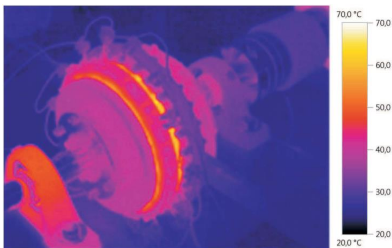
Figura 16 - Imagem termográfica de uma máquina YASA de fluxo axial com potência de 4 [kW].
