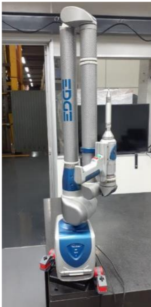
Figura 36 – Equipamento de medição Braço Faro Edge
