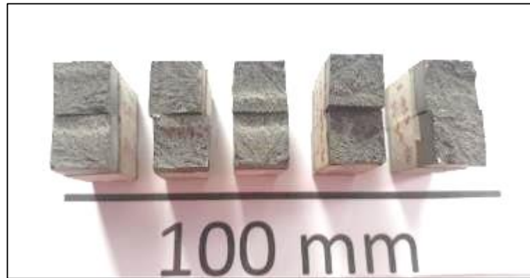
Figura 45 – Corpos de prova de impacto Charpy em austemperado após testes
