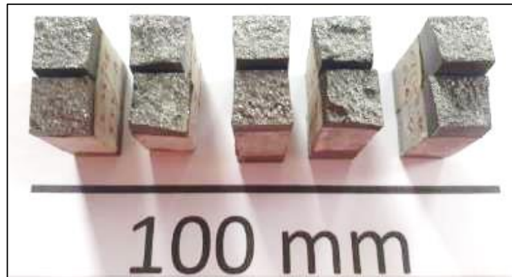
Figura 41 – Corpos de prova de impacto Charpy em ferro fundido nodular após testes
