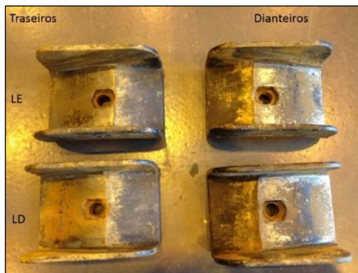
Figura 49 – Conjunto de suportes “ADI#1” devolvidos após teste de campo
