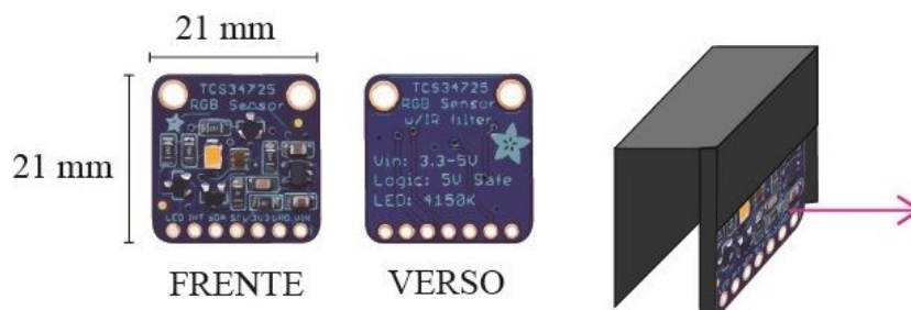
Figura 40. Tipo de componente estrutura de encaixe (d.1.1).
