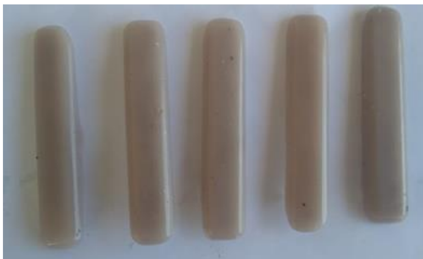
Figura 28- Corpos de prova para ensaio de impacto
