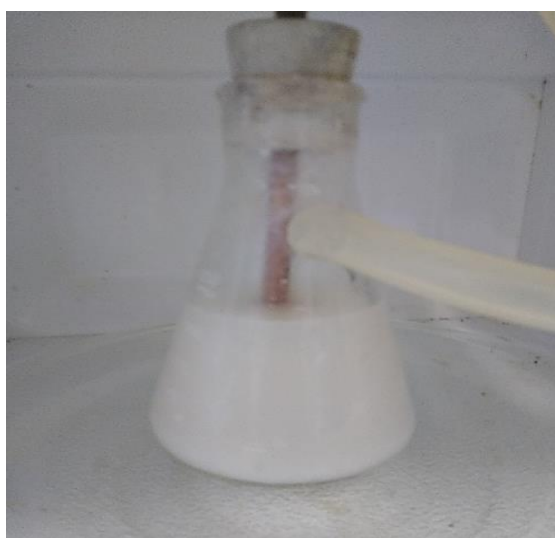
Figura 22-Sistema de remoção do solvente
