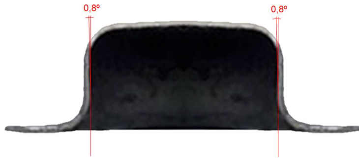
Figura 5.22 - Resultado do retorno elástico angular negativo de 0,8°.
