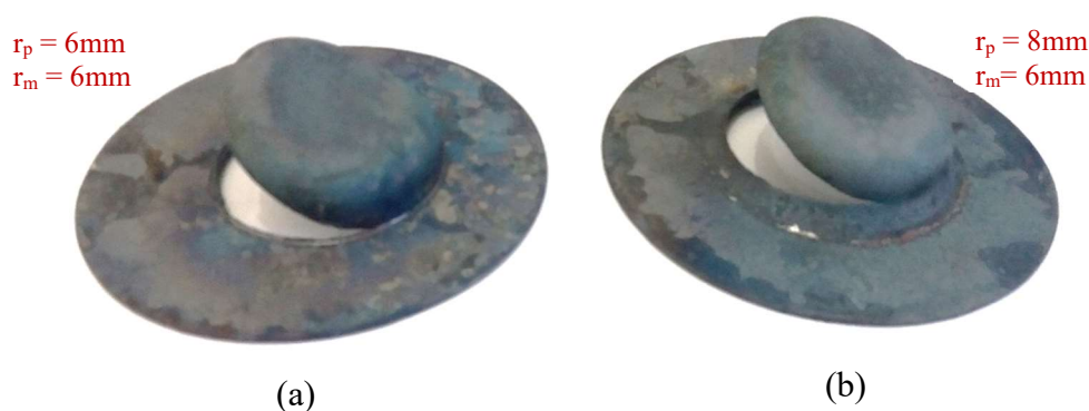
Figura 5.16 - Fratura na zona do canto do punção: (a) Raios da matriz e do punção de 6mm; e (b) Raio da matriz de 6mm e do punção de 8mm.
