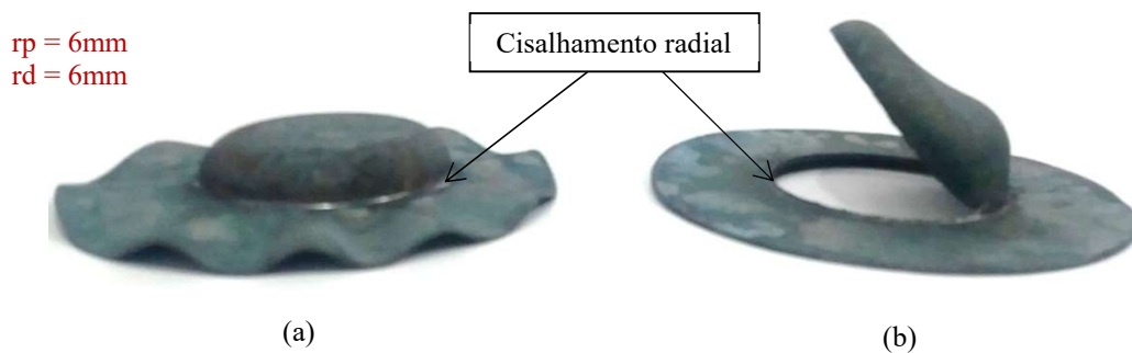
Figura 5.17 - Comparação da atuação de diferentes pressões de atuação no prensa chapas para matriz e punção com raios de 6mm: (a) Pressão 0MPa e (b) Pressão 2 MPa.
