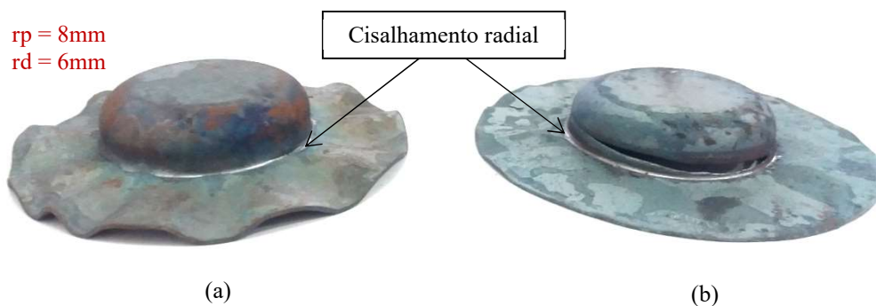
Figura 5.18 - Comparação da atuação de diferentes pressões de atuação no prensa chapas para matriz com raio de 6mm e punção com raio de 8mm: (a) Pressão 0MPa e (b) Pressão 2MPa.
