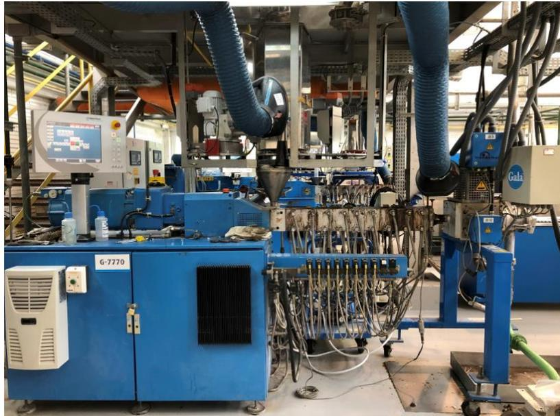
Figura 22: Extrusora dupla rosca ZSK 26 do fabricante Coperion.
