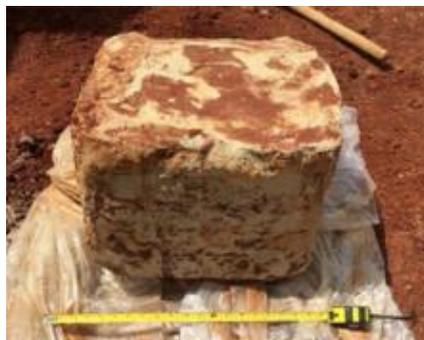
Figura 2.18: Camada (45 mm de aresta) exumada após o ensaio de campo (CONSOLI *et al.*, 2019)
