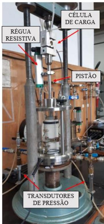
Figura 3.33: Aplicação de carga na amostra
