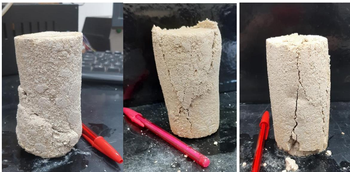
Figura 4.23: Rupturas das amostras CA (a) 20 kPa (b) 60 kPa (c) 100 kPa.
