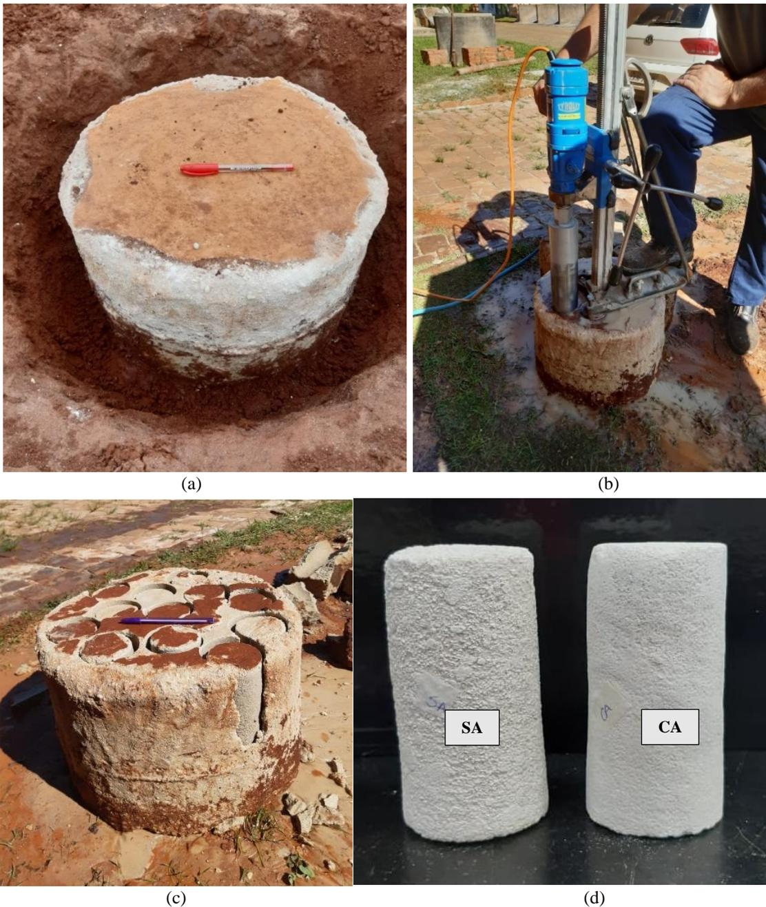
Figura 3.31: (a) Exumação da camada do solo; (b) Extração de corpos de prova das camadas (c) Corpos de prova esculpidos com a serra-copo (d) Corpos de prova esculpidos manualmente
