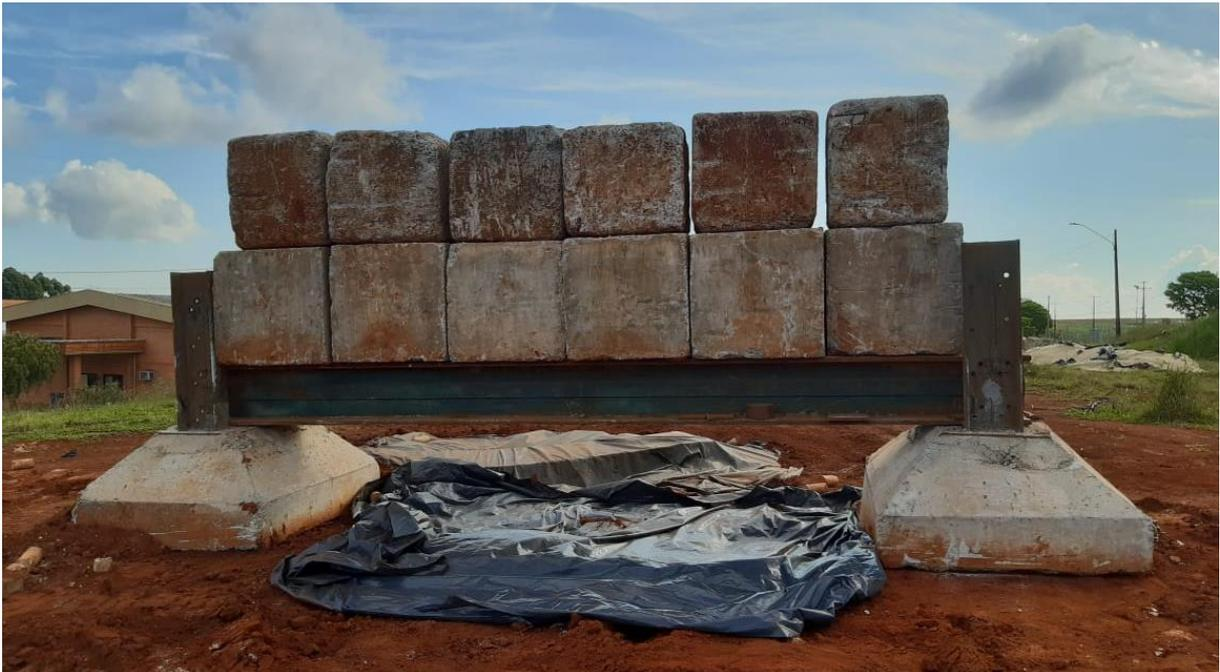
Figura 3.28: Sistema de reação
