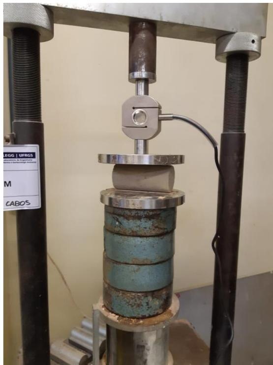
Figura 3.25: Compressão por tração diametral
