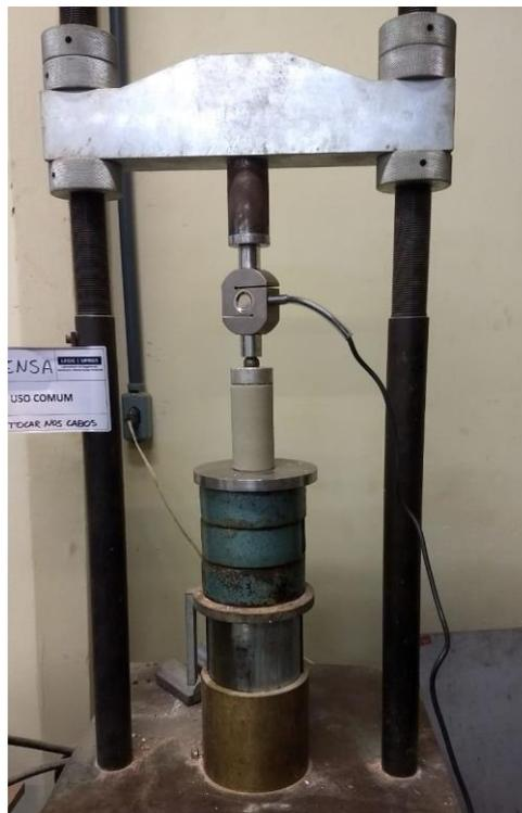
Figura 3.24: Ensaio de resistência à compressão simples
