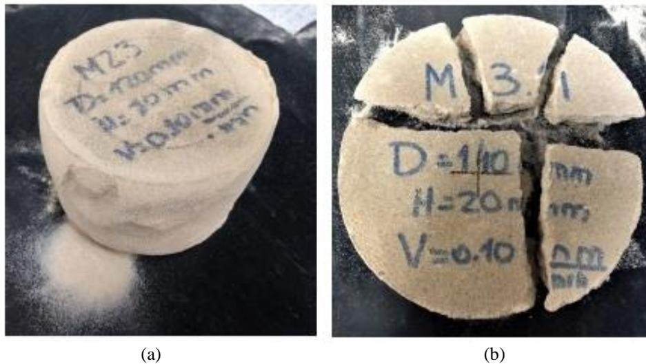
Figura 2.15: (a) Ruptura por puncionamento; (b) Ruptura na camada de reforço (CABALLERO, 2019)
