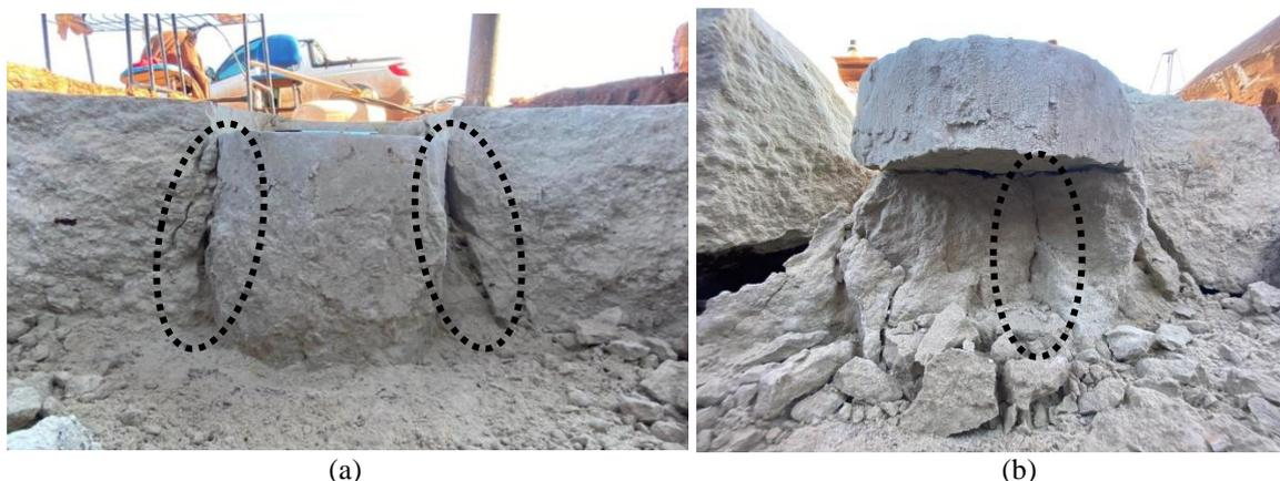
Figura 4.13: (a) Fissuras da base para as bordas da fundação, das laterais para o centro (b) Trinca no centro a baixo da fundação
