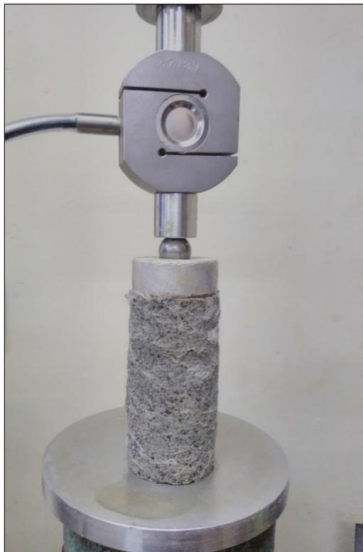
Figura 3.7 - Ensaio de compressão simples.
