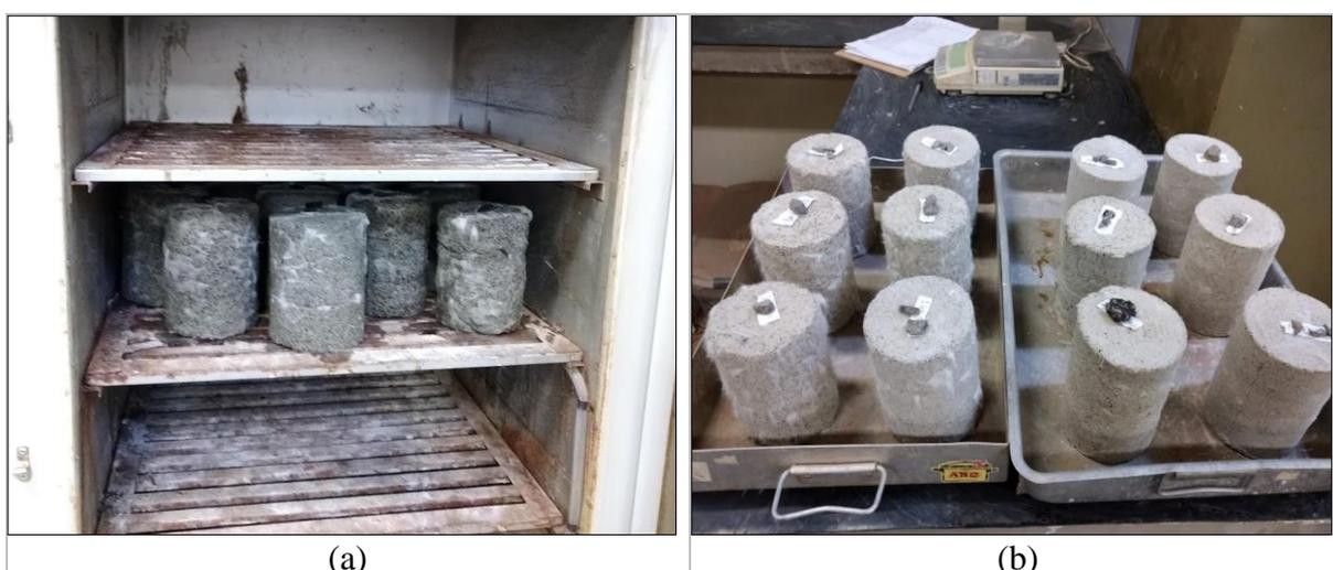
Figura 3.10 - Corpos-de-prova de durabilidade: na estufa (a), prontas para imersão (b).
