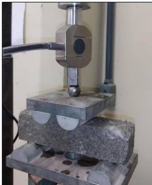
Figura 3.9 – Ensaio de flexão.
