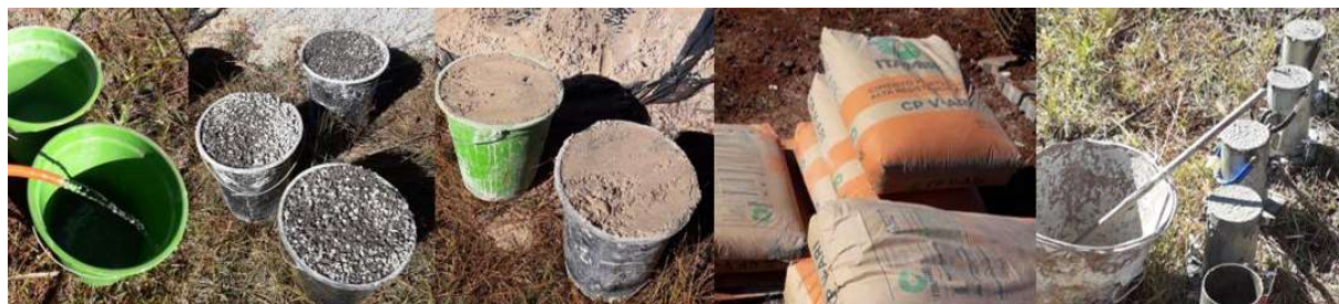
Figura 3.14: Materiais para o concreto e corpos de prova moldados
