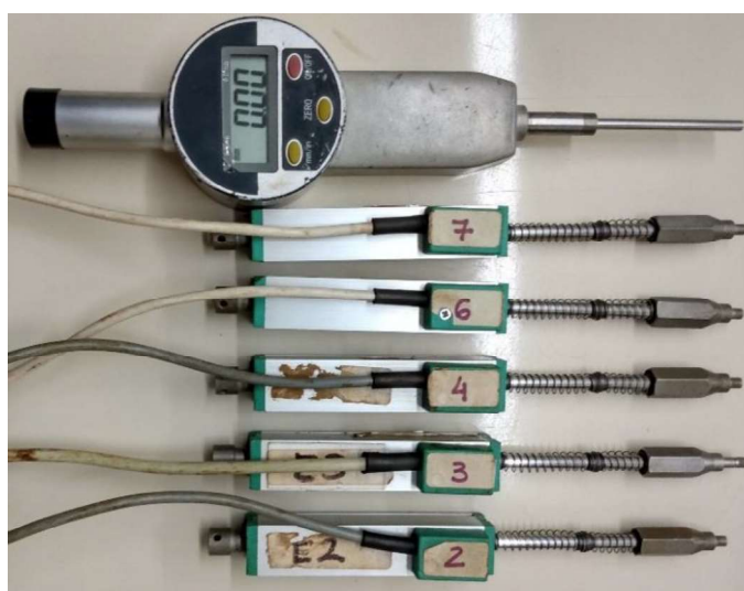
Figura 3.21: Transdutores de deslocamento e relógio comparador
