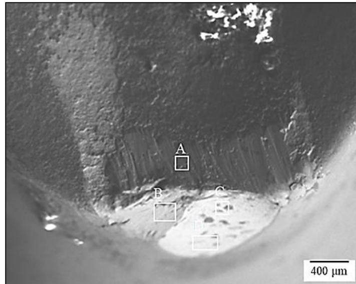
Figura A.8 – Imagem do desgaste de flanco através do MEV com as regiões marcadas para análise EDS para condição MQL com  $v_c = 80$  m/min.
