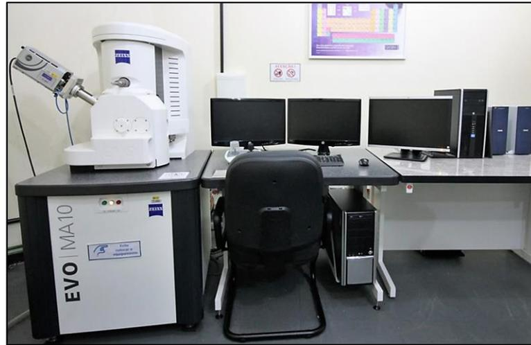
Figura 3.10 – Microscópio eletrônico de varredura e espectrômetro de energia dispersiva.
