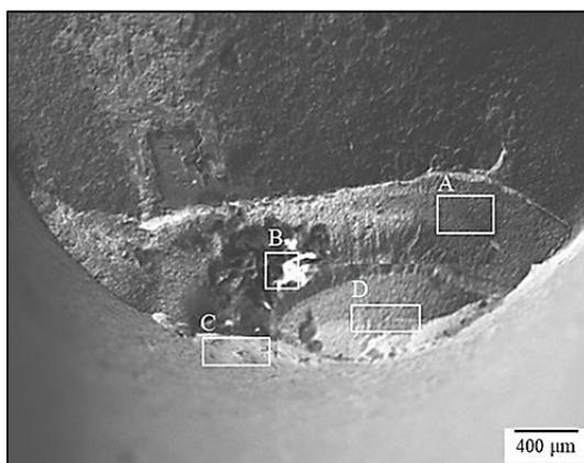
Figura 4.7 – Imagem (MEV) do desgaste de flanco com as regiões marcadas para análise EDS para condição DRY com  $v_c = 80$  m/min.
