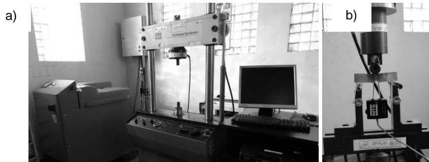
NOTA: Em (a) máquina de ensaio (b) dispositivo e extensometria utilizados nos ensaios ao ar.
