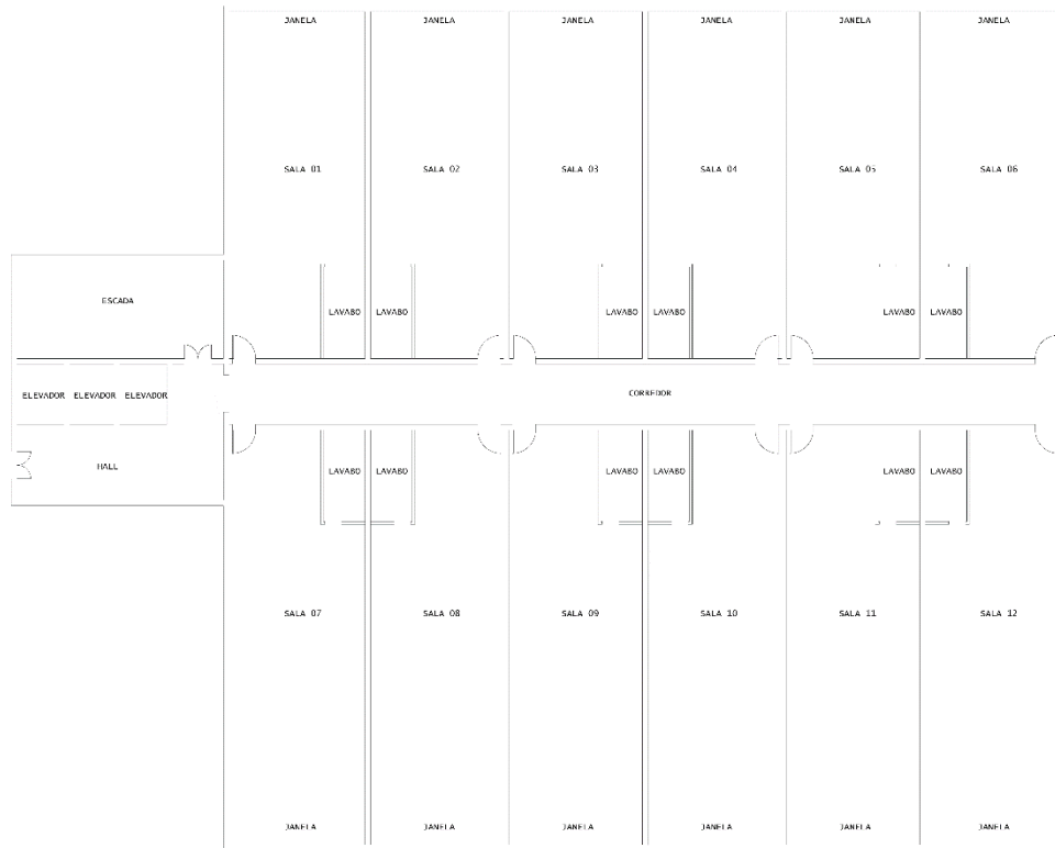
Figura 17 - Planta arquitetônica simplificada do pavimento tipo dos modelos com malha 5x5m
