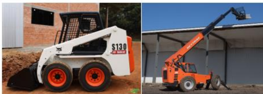
Figura 23 - Maquinário de transporte no canteiro de obras
