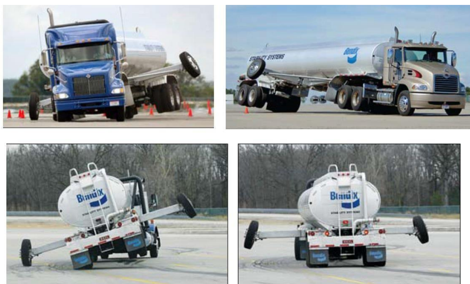
Figura 5 – Teste dinâmico de tombamento lateral
