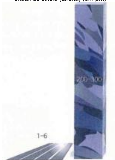
Figura 20 – Comparação de espessuras, entre uma célula de filme fino (esquerda) e uma célula de cristal de silício (direita) (em \mu\text{m} )
