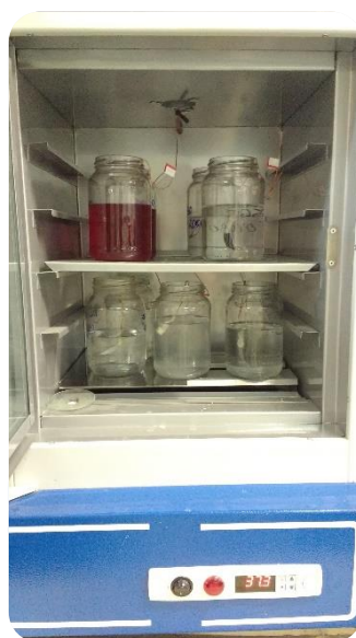
Figura 13 Teste de OCP realizado nas amostras em estufa para manter a temperatura de 37^{\circ}\text{C}
