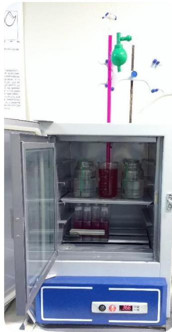
Figura 12 Ensaio de Evolução de Hidrogênio
