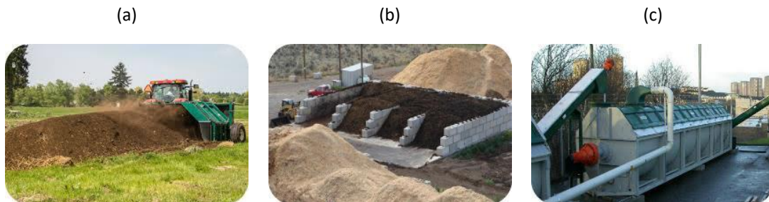
Figura 4.8. Métodos de compostagem: (a) windrow; (b) static pile; e (c) In-vessel.
