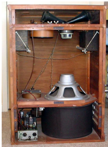
Figura 1 – Construção interna da caixa Leslie.
