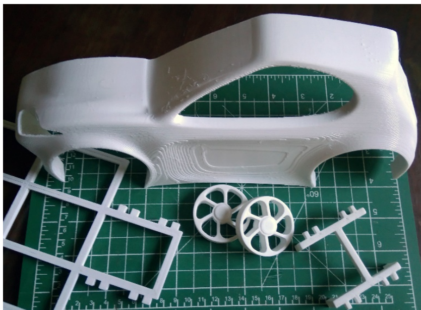
Figura 51 - Impressão da carenagem em partes
