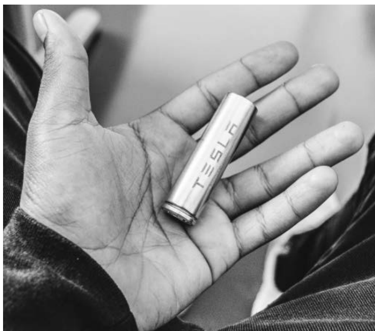
Figura 6 - Bateria 2170 da Tesla
