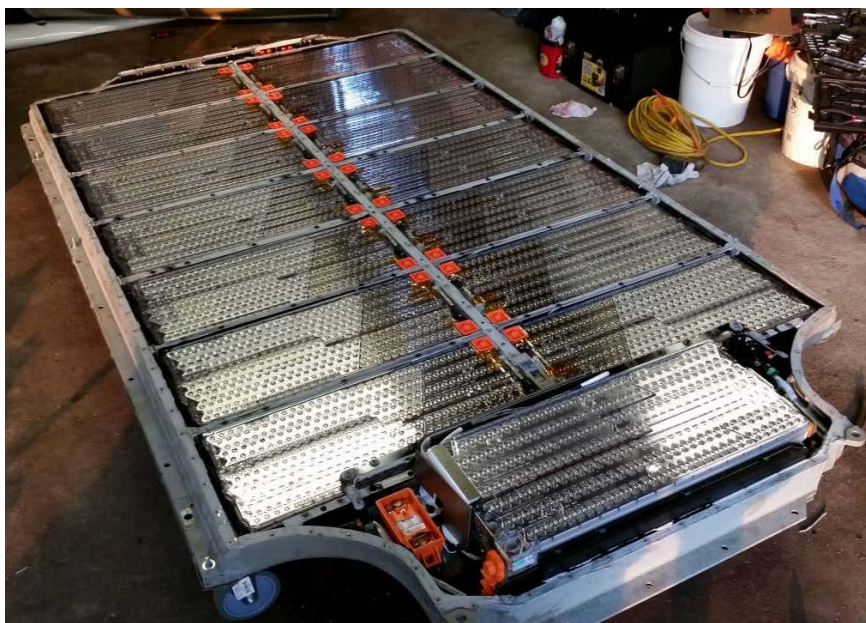
Figura 7 - Células de bateria do Tesla Modelo S
