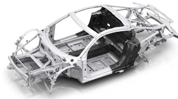
Figura 12 - Estrutura do tipo Space Frame
