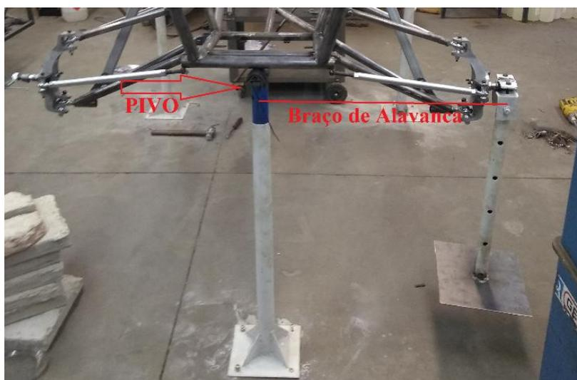
As cargas são aplicadas 3 vezes consecutivas para redução da histerese, em cada lado (na extremidade da suspensão esquerda e direita) alternando a haste da posição. Os deslocamentos são verificados a cada colocação/remoção de peso para se obter a deformação angular em função do torque.
