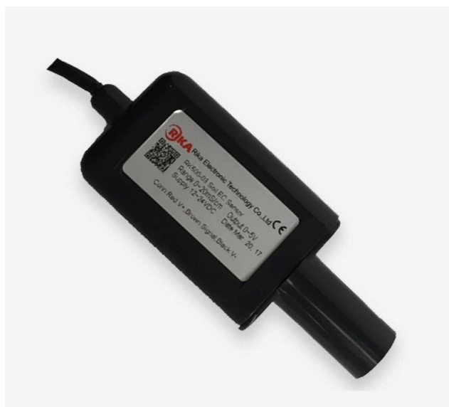
Figura 8 – Sensor de condutividade elétrica utilizado no projeto
