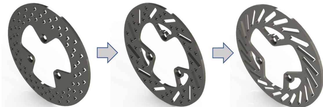
Figura 12. Estudos de otimização do disco de freio. Da esquerda para a direita: Estudo 1, 2 e 3
