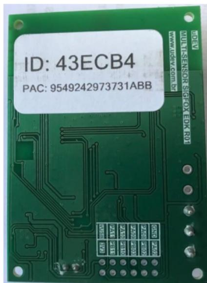
Figura 29: Parâmetros de um Dispositivo com Suporte à Sigfox para Conexão à Rede
