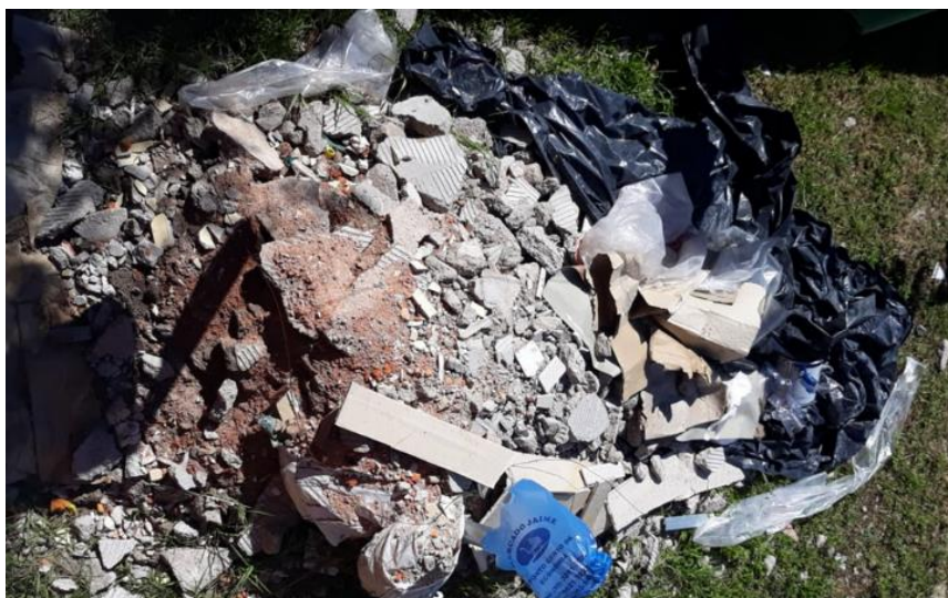
Figura 2: RCD - presença de tijolo, piso, sacola plástica, lona papelão, lata de tinta entre outros
