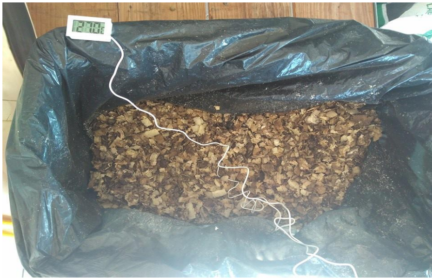
Figura 3: Compostagem do resíduo de alimentos com o termômetro (temperatura ambiente 22º - temperatura da composteira 27º)
