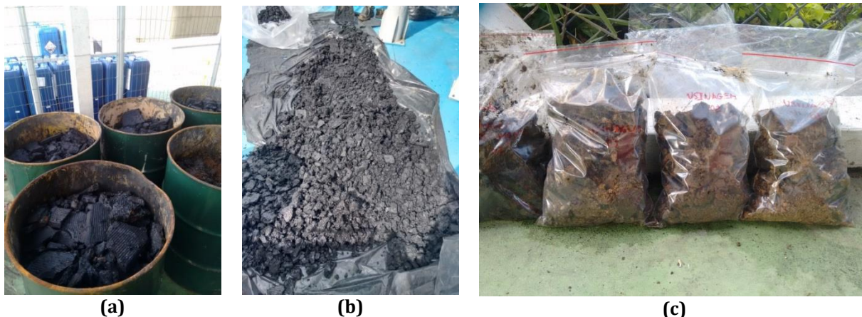
Figura 26: Etapas da amostragem. (a) Armazenamento dos lodos em tonéis metálicos após filtro prensa; (b) Preparo para homogeneização e coleta de amostras de lodo; (c) Amostras de lodo coletadas, armazenadas e identificadas
