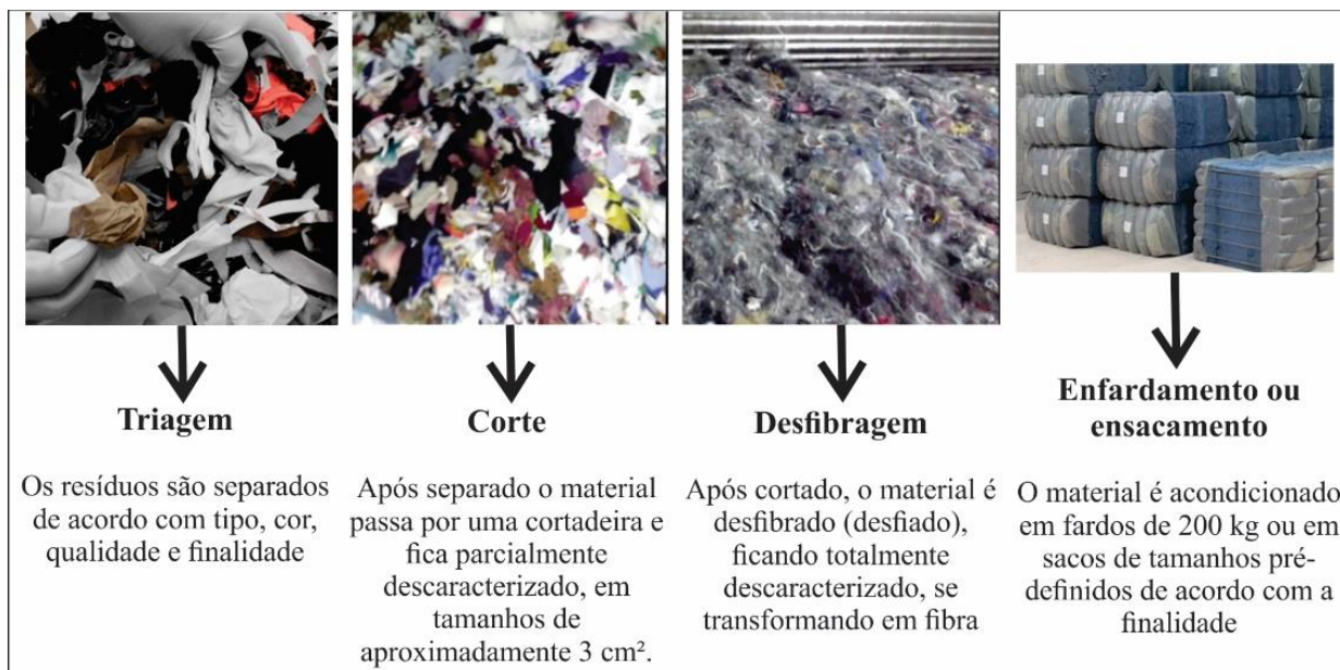
Figura 6: Processo mecânico de reciclagem dos resíduos. Adaptado de Renovar Têxtil e JFFibras. Fonte: https://www.renovartextil.com.br/#!/up e https://jffibras.com.br/index.php
