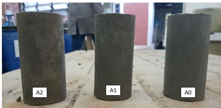
Figura 4: Corpos de prova de argamassa para ensaio de resistência à compressão
