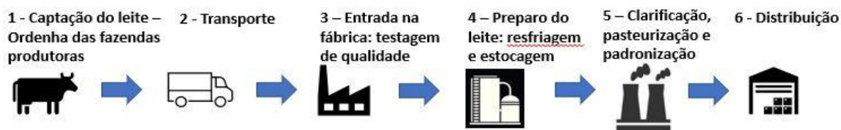
Figura 1: Esquema de produção do leite longa vida. Fonte: elaboração própria (2020)
