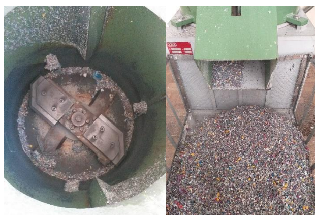
Figura 1: Fotografia da parte interna do aglutinador e do produto aglutinado
