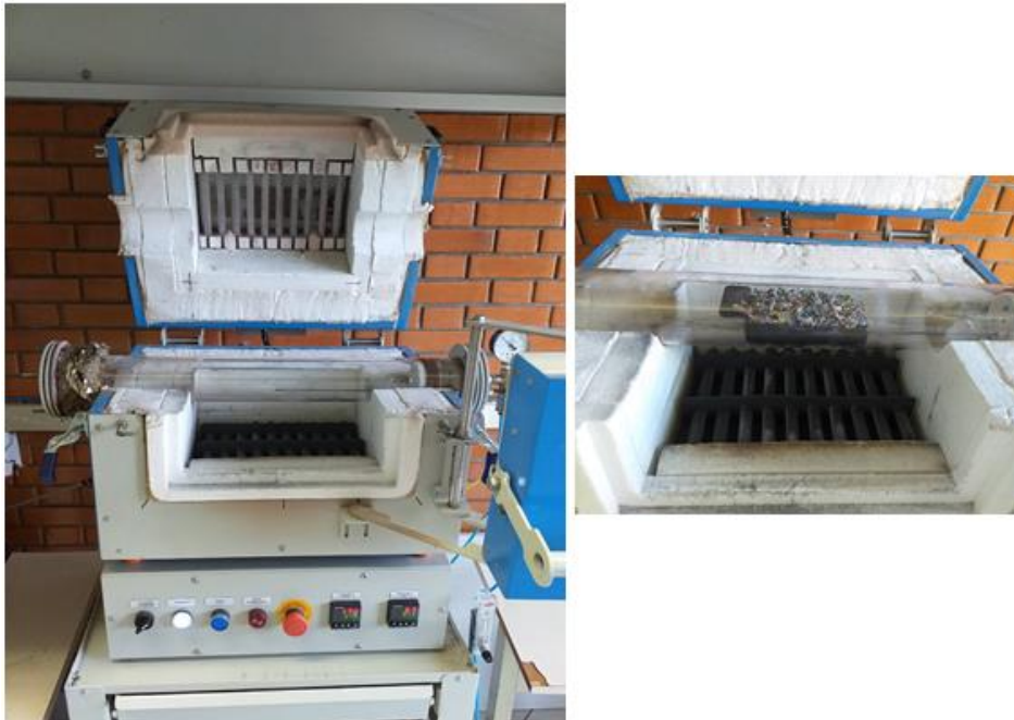
Figura 2: Fotografia ilustrando o reator tubular horizontal utilizado nos ensaios de pirólise neste trabalho
