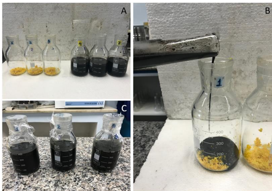
Figura 2: Preparo da mistura substrato-lodo para o ensaio BMP
