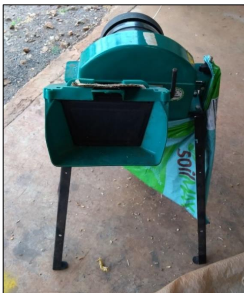
Figura 1 – Moinho forrageiro utilizado para trituração do bagaço de laranja
