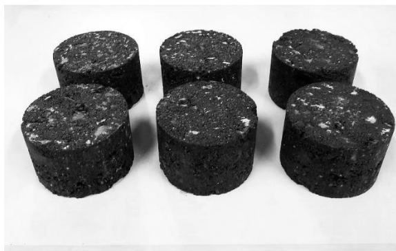
Figura 2: Corpos de prova para o ensaio de resistência à tração por compressão diametral
