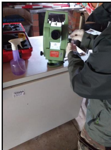
Figura 13 - Higienização da estação total com álcool gel após o uso, fonte autores
