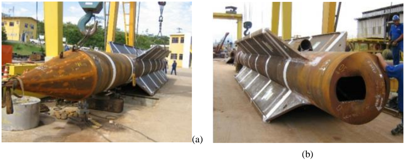
Figura 2.2: Exemplo de âncora torpedo típica (a) ponta cônica e (b) topo. (SAGRILO et al. , 2010).
