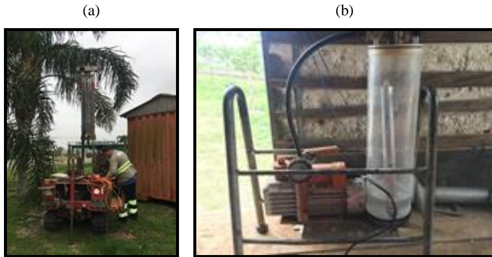
Figura 3.10: (a) Sistema utilizado para a realização dos ensaios CPTu (ensaio realizado no CCMar); e (b) detalhe da ponteira cônica inserida na câmara de vácuo para saturar o elemento poroso.
