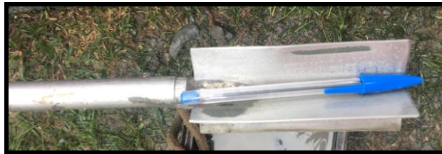
Figura 3.11: Detalhe da ponteira cruciforme utilizada para a realização dos ensaios de palheta.
