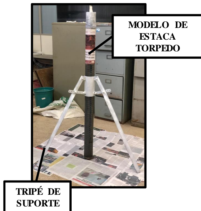
Figura 3.15: Detalhe do sistema tripé – modelo de estaca torpedo durante o processo de pintura.
