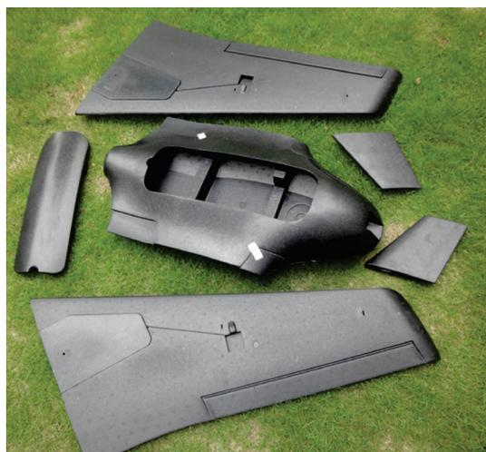
Figura 2. Plataforma de asa fixa modelo Skywalker X8 em kit para montagem
