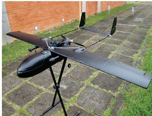
Figura 1. Plataformas de asa fixa modelo Skyhunter (180 cm de envergadura) com revestimento em vinil preto
