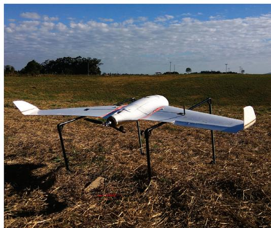
Figura 18. Plataforma X8 pré-modificações, posicionada na catapulta
