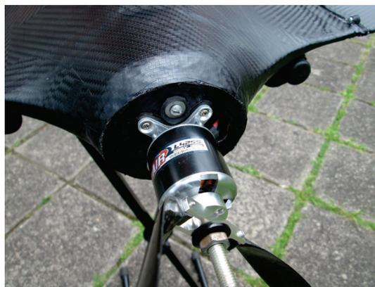
Figura 3. Motor elétrico Turnigy L4255-500 conectado na plataforma X8
