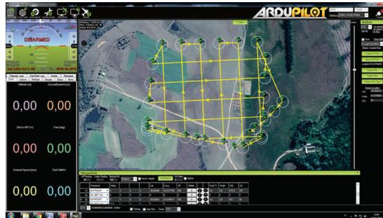
Figura 20. Plano de voo da plataforma X8 com o Software Mission Planner
