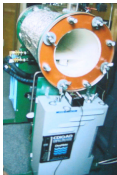
Figura 3. Ozonizador com sistema corona. Fonte: Armstrong et al. (2001).
