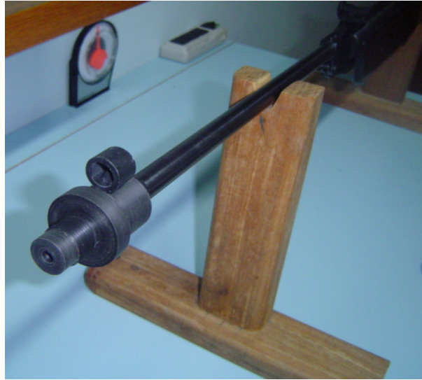
Figura 3.15 - Peça de acoplamento acoplada ao cano
