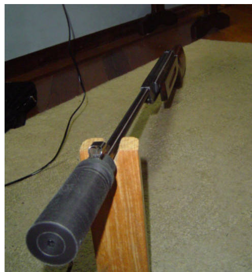
Figura 3.17 - Peça de acoplamento usada acoplada ao cano
