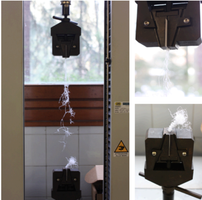
Figura 5.4 - Fratura típica do compósito por tração
