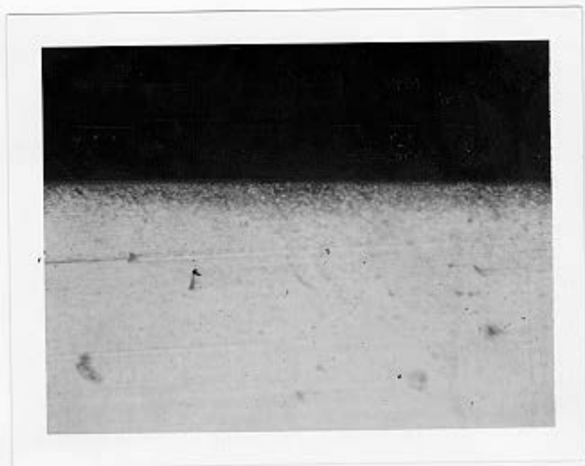
AISI M2 Nitretado Ataque Nital Aumento 400 X
