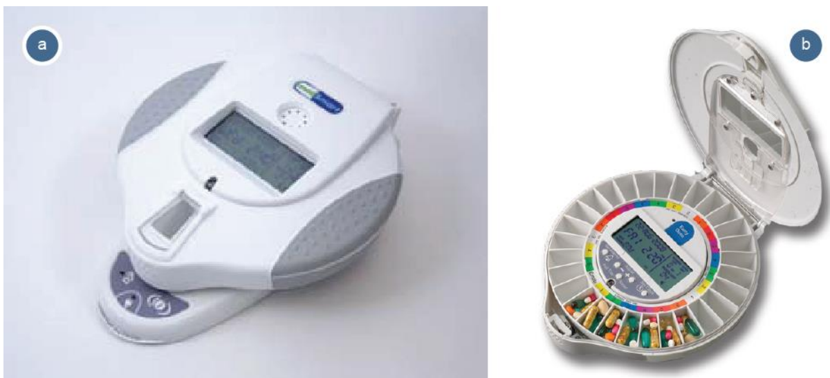
Figura 20: Dispensador de medicamentos da marca E-pill MedSmart. (a) Vista do produto fechado; (b) Carenagem aberta para preparação dos medicamentos. Fonte: www.epill.com/medsmart.html . Adaptado pelo Autor.
