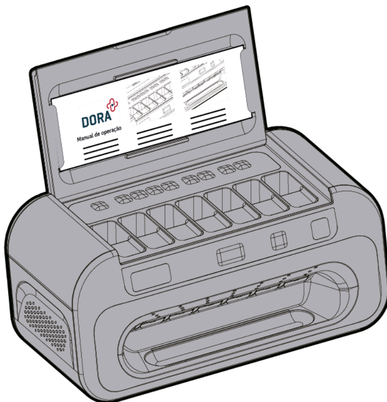
Figura 57: Local para manual de operações do produto. Fonte: Autor
