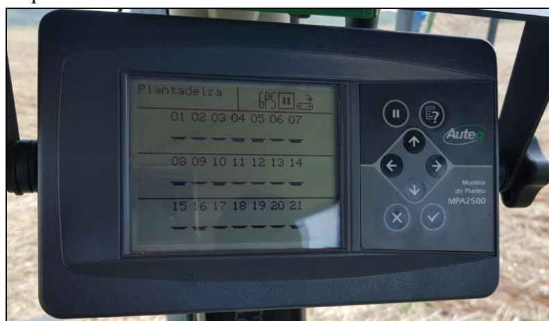
Figura 7 – Monitor de plantio conectado aos tratores e semeadoras.
