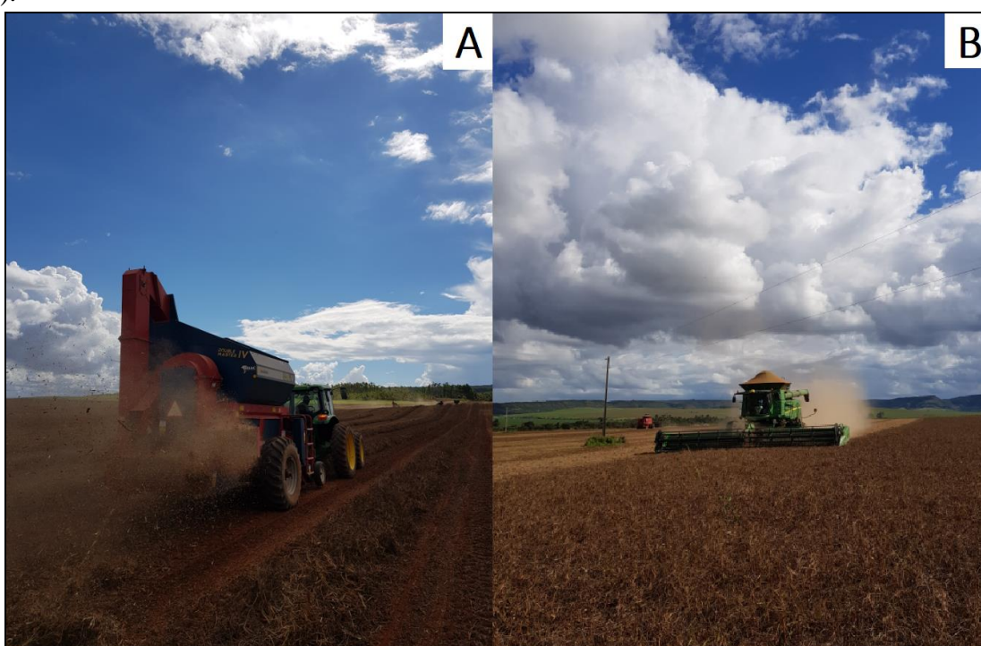
Figura 9 – Colheita de feijão com recolhedora-trilhadora (9A) e com colhedora automotriz (9B).
