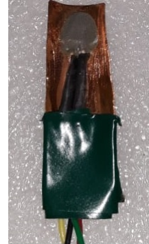
Figura 3.5 – Detalhe do encapsulamento do PT100 com lâmina de cobre.
