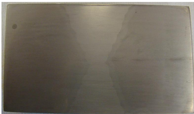
Figura 6.16 – Corpo-de-prova utilizado para medições de dureza nas regiões de soldas
