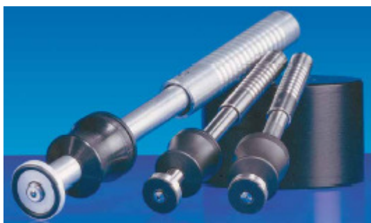
Figura 6.15 – Sondas utilizadas para medições através do processo Leeb Hardness [33].
