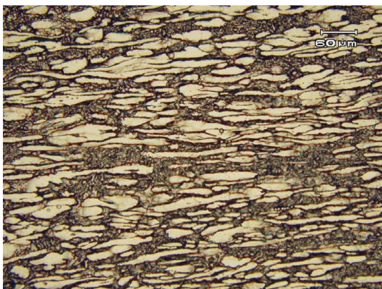
Figura 21 - Material de base como recebido. Behara.
