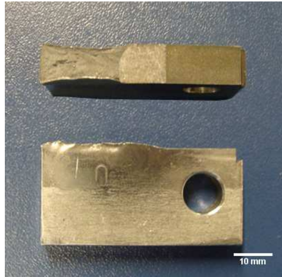
Figura 51 - Corpo de prova do metal de solda rompido no ensaio de tenacidade à fratura ao ar.
