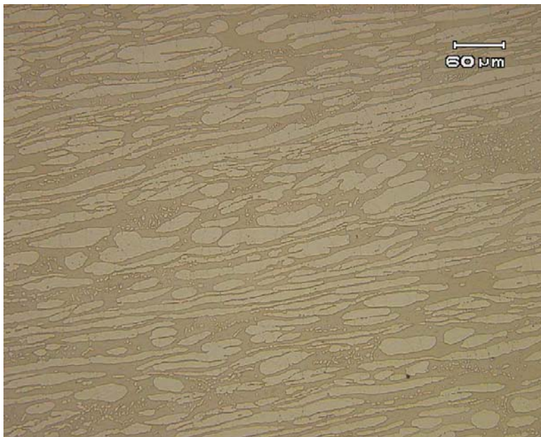
Figura 18 - Microestrutura típica do aço inoxidável super duplex com matriz ferrítica em escuro com ilhas de austenita em branco. Ácido oxálico 10%
