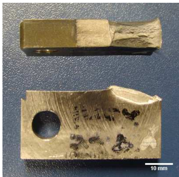
Figura 49 - Corpo de prova da ZTA rompido no ensaio de tenacidade à fratura ao ar.
