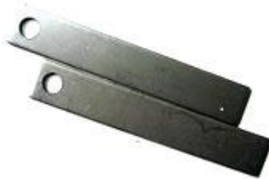
Figura 18 – Exemplos de corpos de prova utilizados nos testes eletroquímicos
