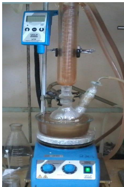
Figura 17 – Sistema Reacional montado
