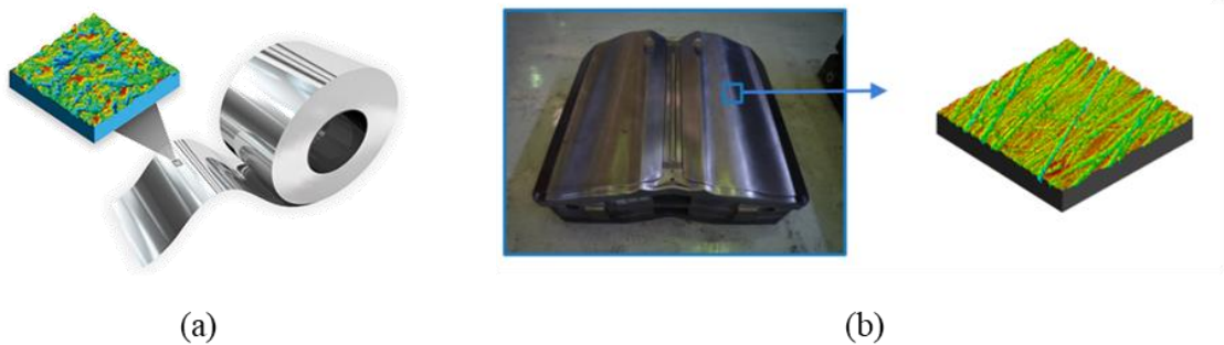
Figura 3.14 – Rugosidade da chapa (a) e da ferramenta (b). [Fonte: Tribiform, 2013]
