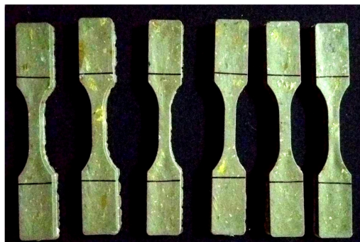
Figura 25 - Imagem fotográfica dos corpos de prova de tração tipo V utilizados para ensaio de resistência à tração.
