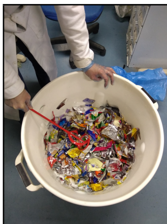
Figura 24: Tanque de lavagem utilizado com resíduos imersos na solução de detergente.
