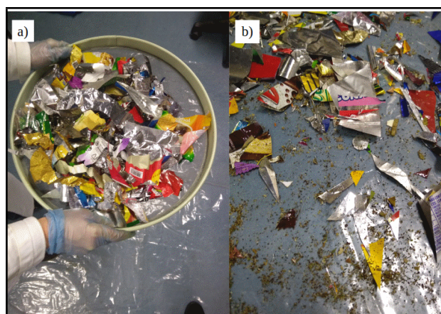
Figura 23: a) peneiramento das amostras após picotamento manual. b) resíduos em forma fina descartados após peneiramento.
