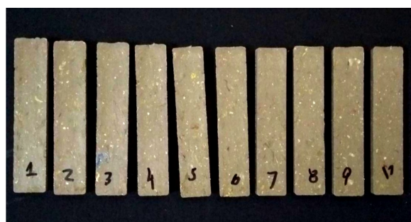
Figura 26 - Imagem fotográfica dos corpos de prova utilizados para ensaio de resistência ao impacto.
