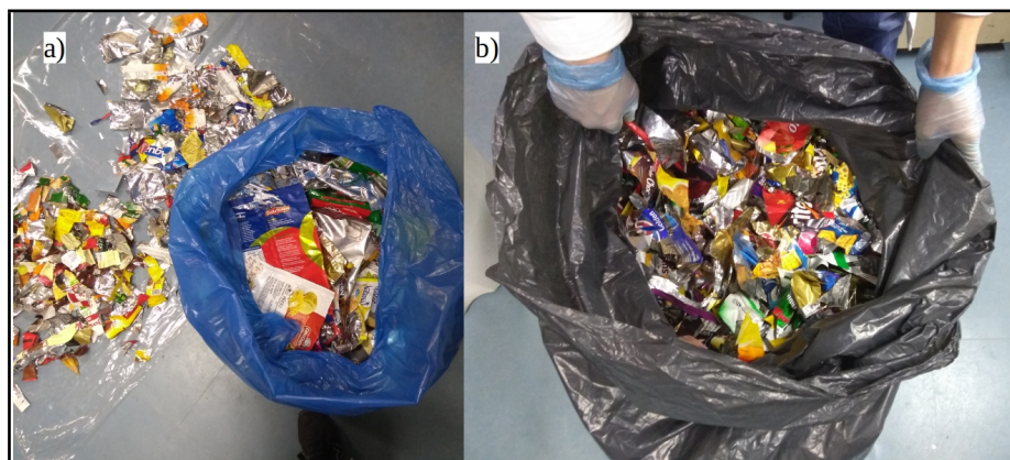
Figura 22: a) picotagem manual seguido de b) homogeneização com auxílio de uma pá de mistura.
