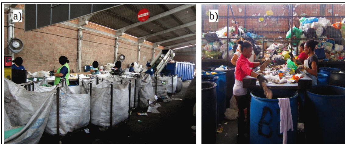
Figura 32: Imagens das unidades de triagem: a) esteira utilizada para a triagem de resíduos pela Cooperativa de Educação Ambiental e Reciclagem Sepé Tiaraju, ou Frederico Mentz, e b) mesa de triagem no Centro de Triagem Vila Pinto.
