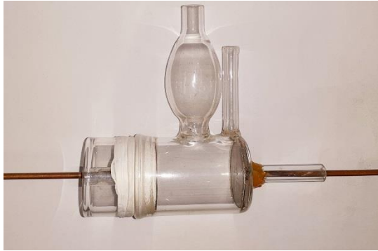
Figura 14: Célula ôhmica utilizada para determinação da condutividade elétrica
