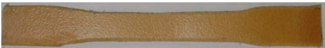
**Figura 21: Corpo de prova para ensaio de tração ASTM tipo I com medidas padrão**
