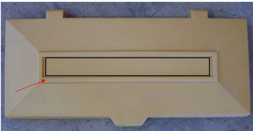
**Figura 19: Peça processada em termoplástico reforçado com farinha de madeira usada - em destaque seção usada para realização de ensaios.**
