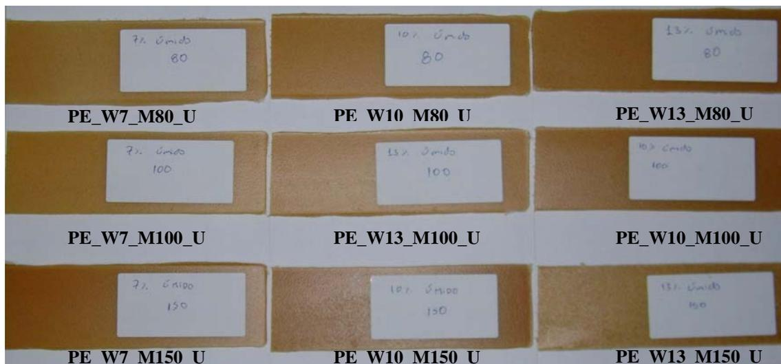
Figura 46: Amostras feitas com farinha de madeira úmida e avaliadas quanto ao aspecto visual
