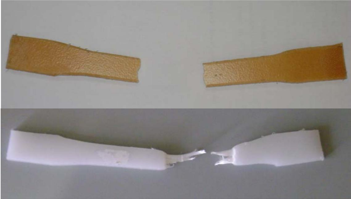
**Figura 22: Corpo de prova após ensaio de tração (acima PE Carregado com farinha de madeira e abaixo PE puro usado como referência)**
