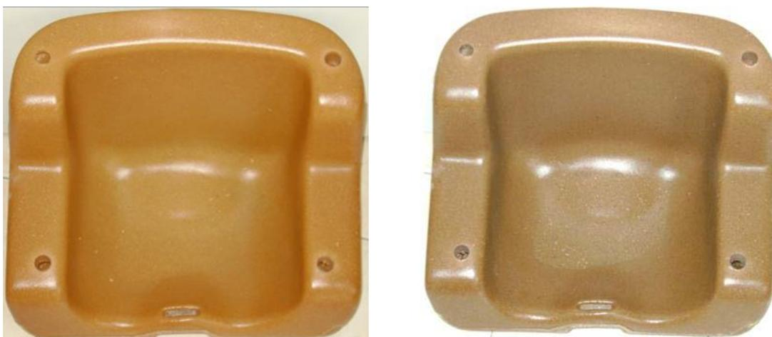
**Figura 49: Balanços feitos com PE carregado com farinha de madeira (carga de Pinus a esquerda e MDF a direita)**
