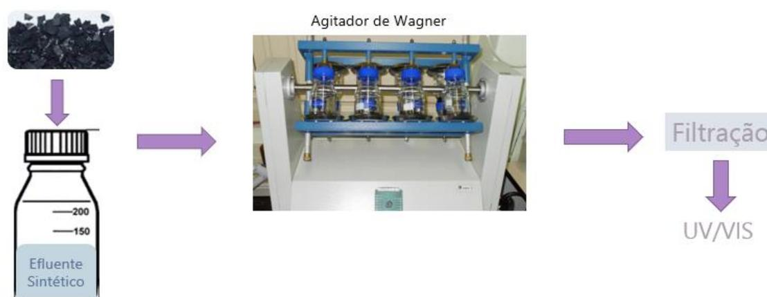
Figura 7: Metodologia aplicada nos ensaios de adsorção
