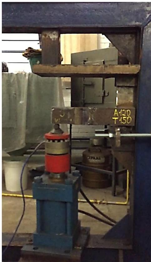
Para a realização dos ensaios dinâmicos de impacto torcional também foi desenvolvido no LS&TC um dispositivo que possibilita a aplicação do carregamento de maneira precisa e eficaz, trata-se de um martelo de impacto estrutural, semelhante aos utilizados nos ensaios charpy (KOBAYASHI, 2002). No Anexo B pode-se observar seu detalhamento.
