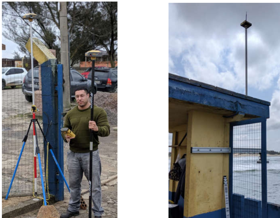
Figura 62: Rastreo dos pontos com GNSS Topcon Hiper Lite+ (esq.: base local no ponto MG EST; dir.: rover no ponto Vértice GNSS Geodésico).
