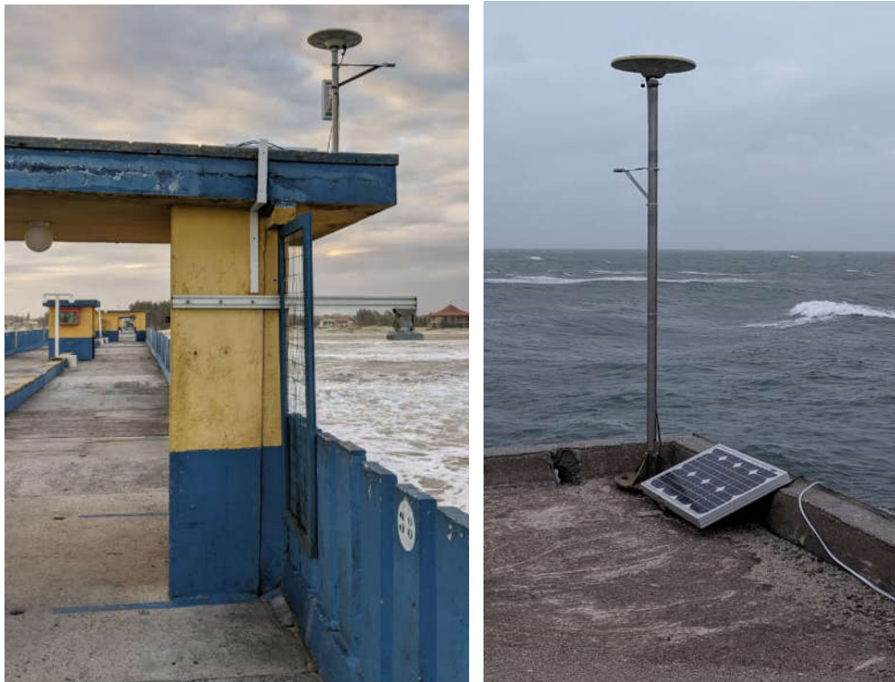
Figura 56: (Esq.) GNSS Geodésico com o mastro curto sobre o marégrafo; (Dir.) Detalhes do GNSS Geodésico com o mastro longo sobre o marégrafo.
