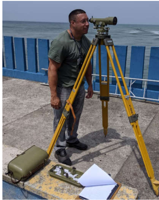
Figura 66: Nivelamento geométrico com nível óptico analógico (WILD N3) de bolha bi-partida.
