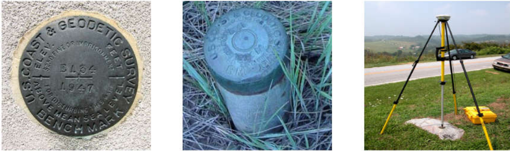
Figura 72: Da esquerda para a direita, foto tipo zoom, foto de pé, e foto do horizonte. Adaptado de: National Geodetic Survey. Disponível em: https://www.ngs.noaa.gov/surveys/mark-recovery/mark-descriptions-help.shtml#photos
