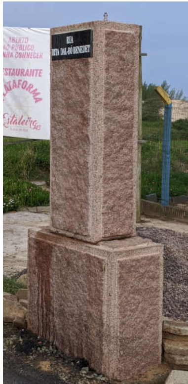
Figura 38: Marco Geodésico de granito (MG POR) na entrada da plataforma de pesca onde foi instalado o pino de centragem forçada.
