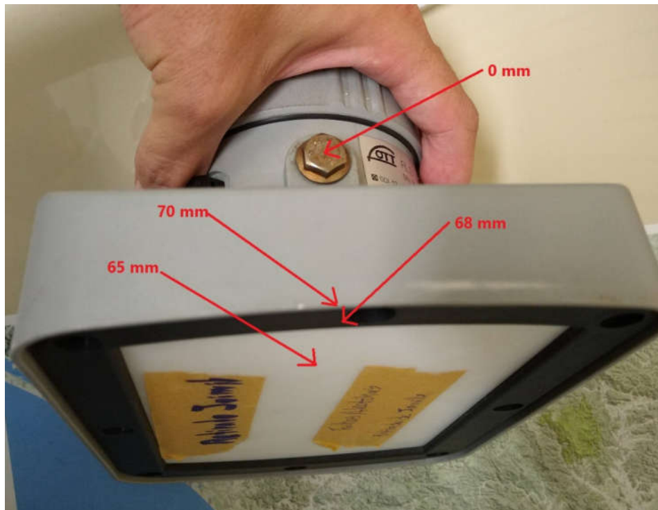
Figura 82: Esquema de medidas fornecidas pela EPAGRI e confirmadas pelo fabricante.
