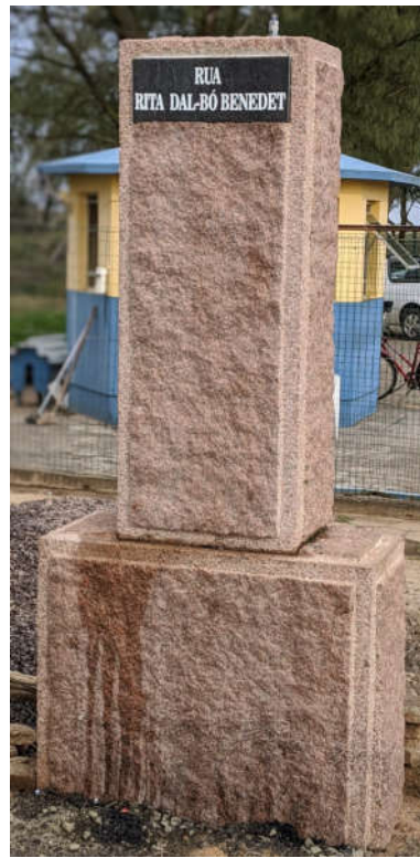
Figura 38: Marco Geodésico de granito (MG POR) na entrada da plataforma de pesca onde foi instalado o pino de centragem forçada.
