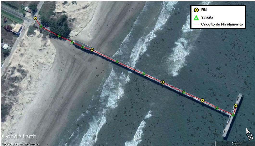
Figura 79: Circuito de nivelamento geométrico para o nível GEODETIC DL-202.
