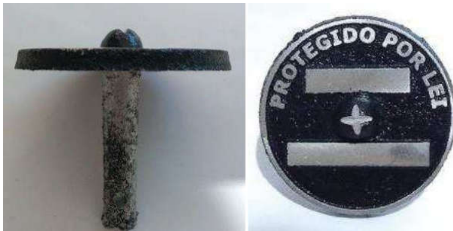
Figura 11: Exemplar de plaqueta metálica para RN.
