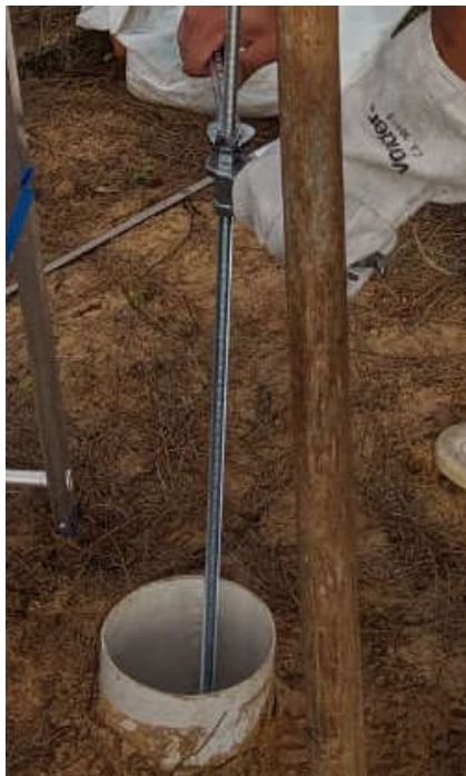
Figura 46: Detalhe da conexão de duas hastas rosqueadas através da luva de conexão e duas porcas de fixação (além da trava química).
