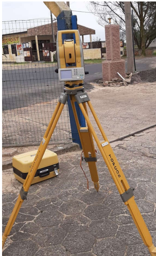
Figura 71: Nivelamento trigonométrico entre a RN da EPAGRI na entrada da plataforma e o pino de centragem forçada materializado.
