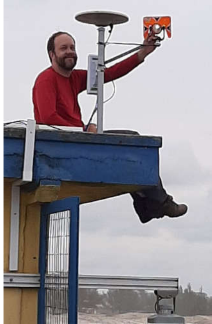
Figura 70: Nivelamento trigonométrico, entre a RN da EPAGRI e o GNSS Experimental junto ao mastro do GNSS geodésico, utilizando prisma.
