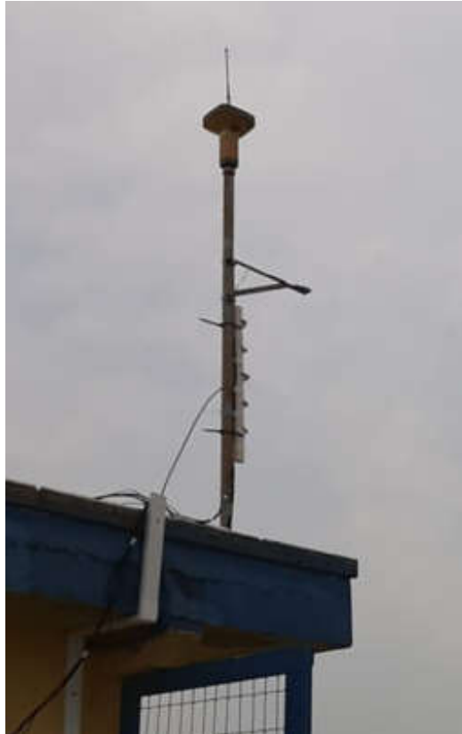
Figura 61: Receptor GNSS GR3 Topcon (rover) no Vértice GNSS Geodésico.
