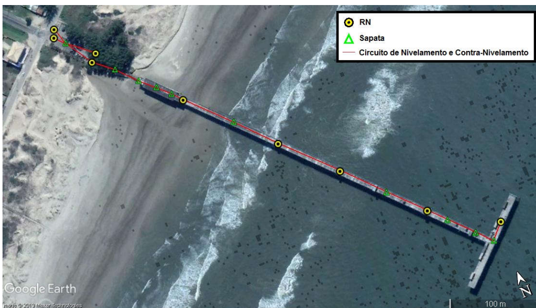
Figura 80: Circuito de nivelamento geométrico para o nível WILD N3.
