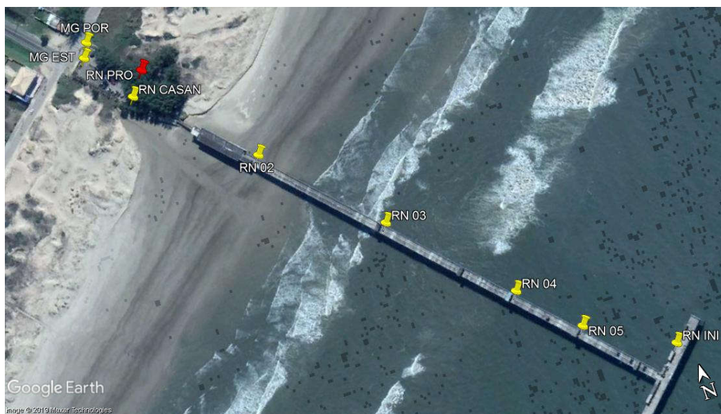
Figura 40: Croqui de localização aproximada das RNs; as RNs numeradas de 02 a 05 são as novas implantadas; a RN 05 é a mais próxima do marégrafo; a RN INI (M110) é a RN de partida do nivelamento geométrico; os vértices MG são os marcos geodésicos localizados no estacionamento (MG EST) e logo no portão da plataforma (MG POR).
