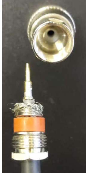
Figura 55: Cabo coaxial confeccionado.
