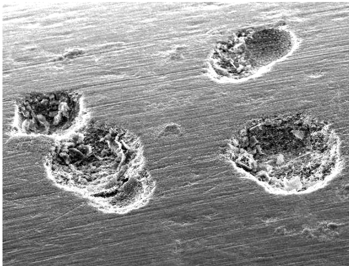
Figura 101: Micrografia do TiAl4V no tampão McIl Vaine pH 2 contendo 0,1 \text{ mol.L}^{-1} NaBr, após voltametria cíclica entre -1 e 4 \text{ V} obtida na varredura reversa em 1 \text{ V} .
